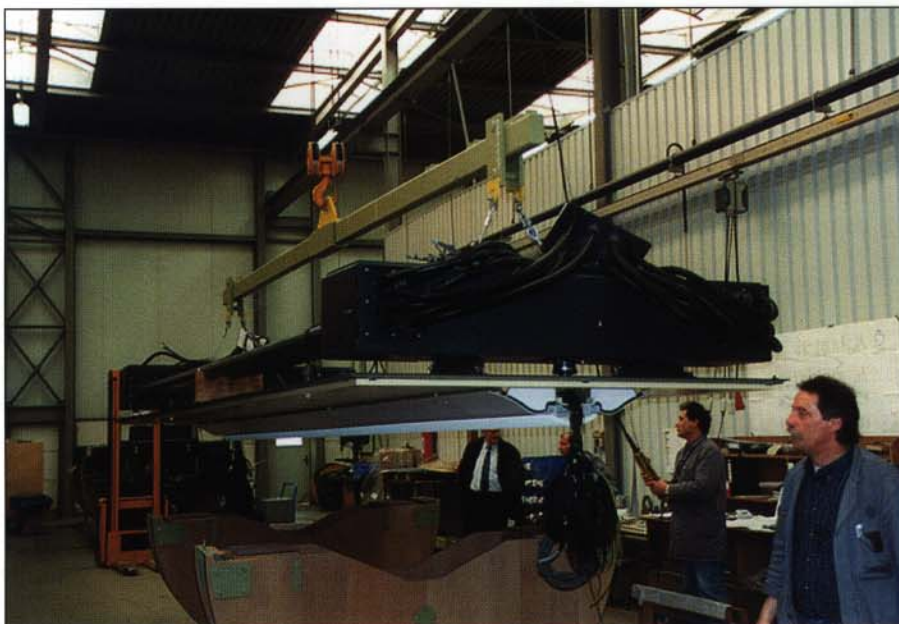
Bild 7: Aufkleben des komplett vormontierten und geprüften Sandwichdaches eines COMBINO®-Mittelmoduls
