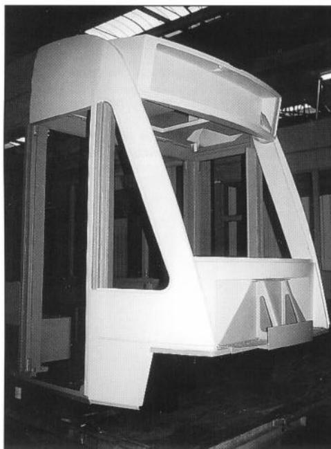
Abb. 5: Aluminium-Rohbau mit aufgeklebtem Kopf in Kunststoff-Sandwich-Bauweise und aufgenieteter Querversteifung
