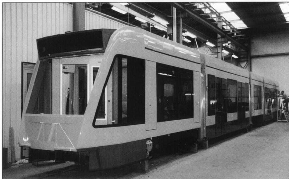
Abb. 7: Prototypfahrzeug des Combino nach dem Kuppeln der Wagenkästen
