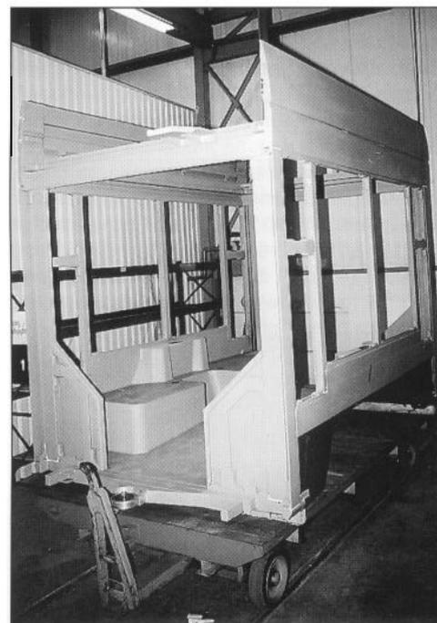
Abb. 3: Zweiachsiges Fahrwerkmodul nach dem Grundieren
