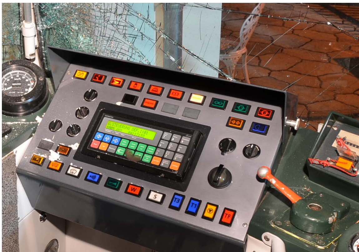
Foto 2: Tastenanordnung im Führerstand (Tasten sind nahe nebeneinander)
